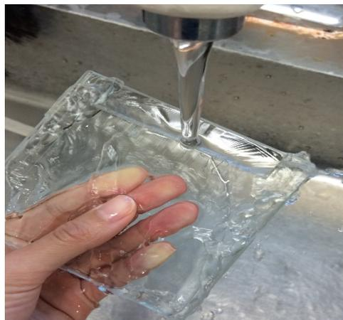
(12) コームとシリコンゴム、クリップをはずし、ガラス板ごとコーム側の部分を水道水で流す。
