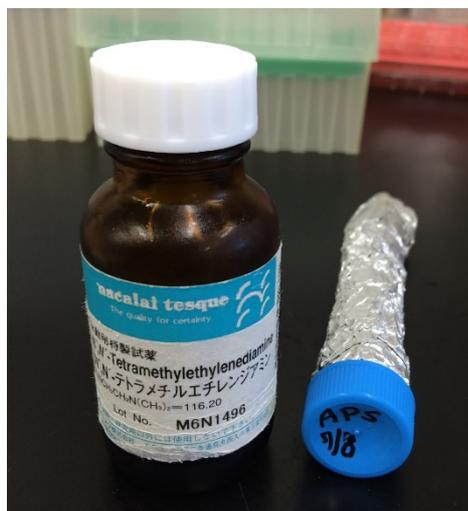
(10)stacking のフラスコに(6)と同様の要領で APS $24\mu\text{l}$ ,TEMED $2.4\mu\text{l}$  をいれてよく混ぜる。
