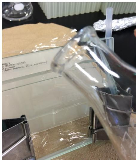
(7) ガラス板の間に、separating の試薬を流し込む。
