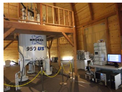
950MHz 超高感度 LC-NMR 装置
